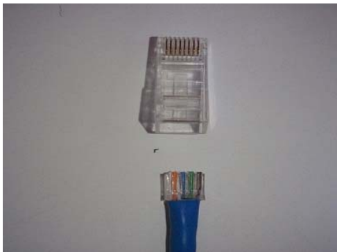
9. ทำการสอดสายพร้อมกับ pre-insert bar เข้าไปในตัว RJ-45 โดยดันให้ pre-insert bar ไปอยู่ใต้เข็มทองแดงของตัว RJ-45
