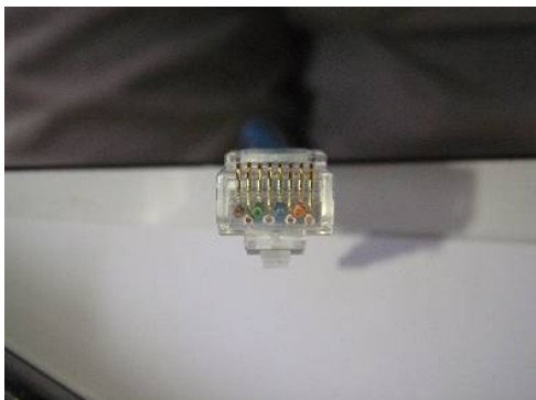
11. ตรวจสอบปลายสายทองแดง จะต้องชนขอบของตัว RJ-45 โดยเรียงเสมอกัน
