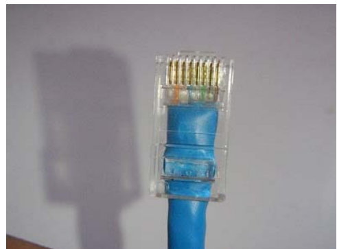
12. เมื่อตรวจสอบถูกต้องแล้ว ก็ใช้คีมสำหรับเข้าหัว RJ-45 ทำการย้ำสายให้แน่น เพื่อทำการกดเข็มทองแดง และล็อคสายไม่ให้หลุด
