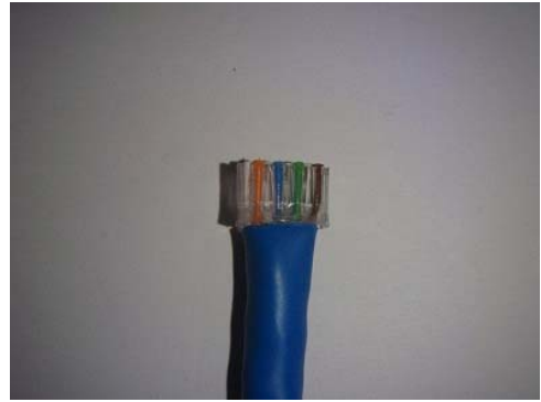
8. ใช้กรรไกรตัดสาย หรือ คีมตัดสาย ตัดปลายสาย ให้พอดีกับขนาด pre-insert bar
