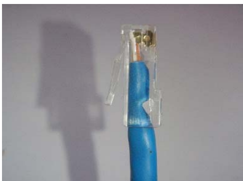
13. ตรวจสอบความเรียบร้อยของหัว RJ-45 ว่ามีการล็อคแน่นหรือไม่ เข็มทุกอันกดลงตรงสายที่จัดเรียงไว้ถูกต้องหรือไม่
