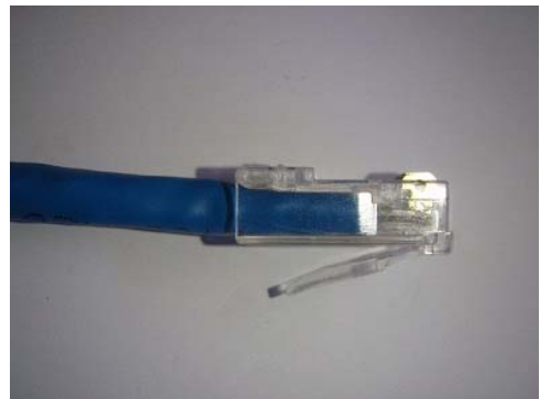
10. ทำการตรวจสอบว่า pre-insert bar เข้าไปอยู่ภายใน และอยู่ใต้เข็มทองแดงของตัว RJ-45 ตามรูปตัวอย่าง
